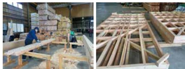
機械でカバーできない複雑なものは、専属の大工さんが匠の技で加工。最新コンピューター技術による加工と職人技を融合させ、高精度・高強度な品質を確保。大黒柱・丸太など、様々な大きさの木材加工に対応されていました。
