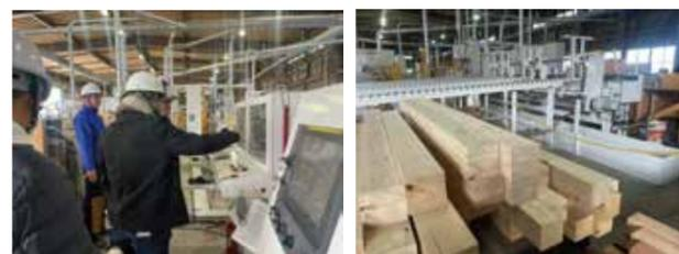
平安コーポレーション製の柱加工機が1機、横架材加工機が1機フル稼働。1日で住宅2棟分の加工能力があるそうです。
