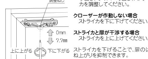
扉とブレーキ受け座が干渉する場合は取付ねじをゆるめ、前後に調整してください。
